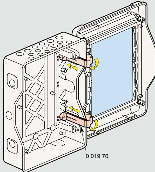
Шарниры соединяют заднюю и лицевую части корпуса щитка
